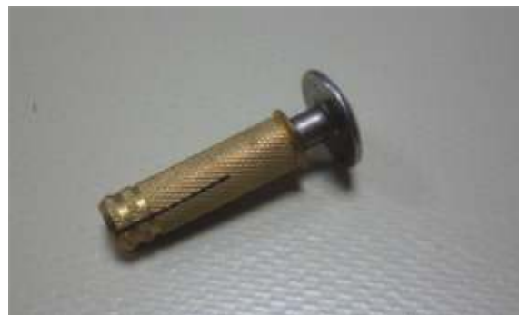
Anclaje 2 piezas Taco latón y Tornillo Inox. Taco: 35mm x 10mm. M8 Broca 10mm Tornillo Inox con rosca parcialmente pulida para no dañar goma tensora
